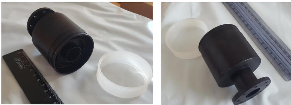
Облучатель Ки диапазона для приемных спутниковых антенн осесимметричного типа с  $F/D=0,4$  для приема сигналов любых поляризаций.
