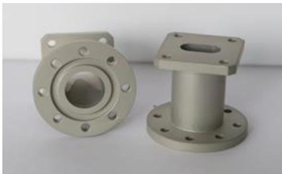
Переход предназначен для соединения волноводов круглого и прямоугольного сечения для использования в составе антенно-фидерных трактов приёмных антенн.
